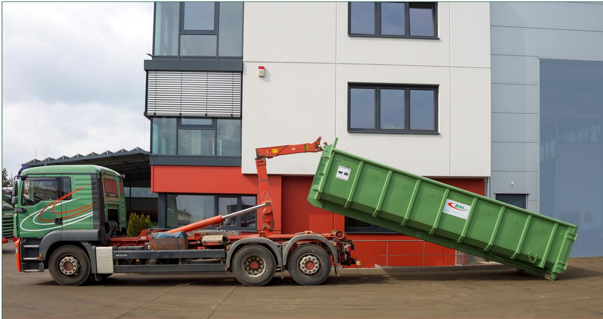
**Platzbedarf Abroller zum Absetzen des Behälters** - das Fahrzeug muss nach vorne wegrollen können
